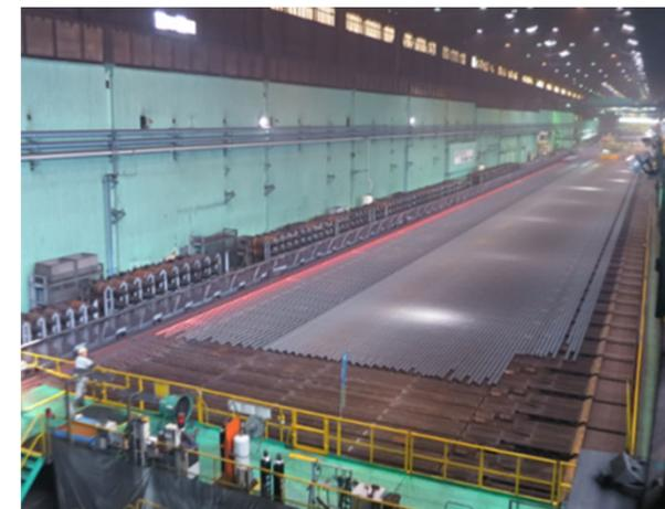
145mの長尺冷却床（堺工場）
